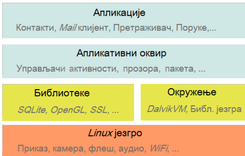
Слика 1. Архитектура Android оперативног система
