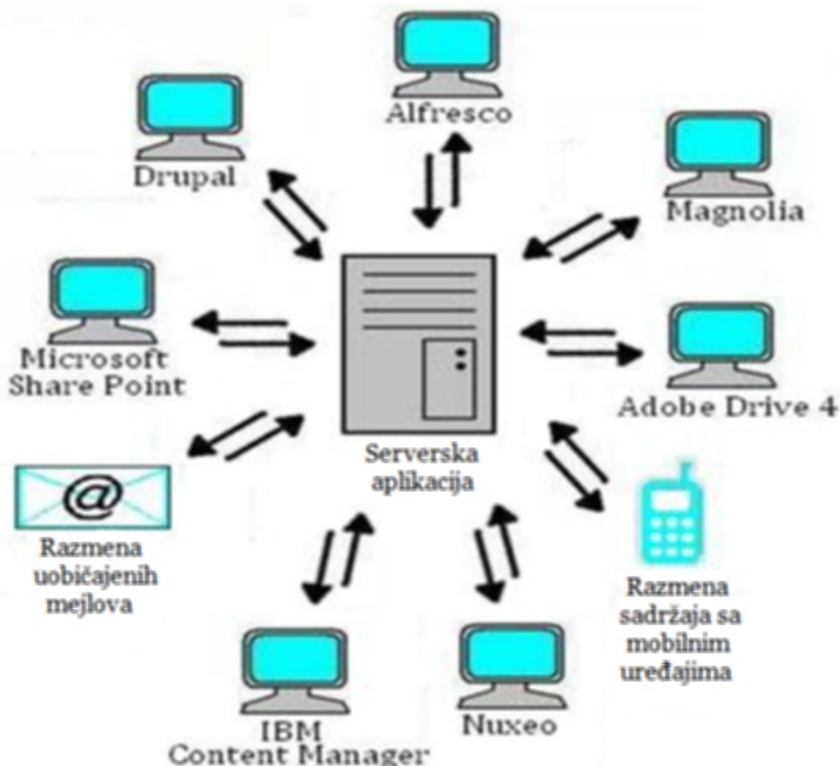
Слика 4: Дијаграм серверске апликације која као посредник користи CMIS протокол за размену докумената између различитих система.
