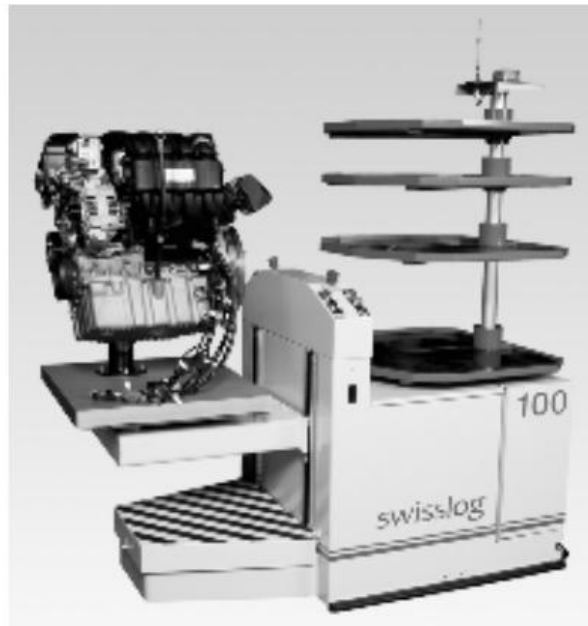
Slika 1.1: SWISSLOG-ov AVG robot korišćen za transport blokova motora od jedne montažne stanice do druge. Vođen je električnom žicom ugrađenom u pod [1].
