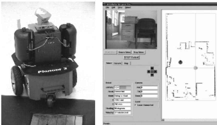
Slika 1.5: PIONEER je modularni robot koji nudi razne opcije kao što su hvataljka ili ugrađena kamera. Opremljen je sofisticiranom bibliotekom za navigaciju koji su razvili SRI , SA , Stanford [1]
