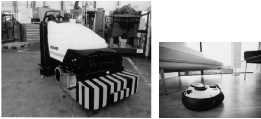
Slika 1.3: BR 700 industrijski robot za čišćenje(levo) i RoboCleaner RC 3000 potrošački robot koje je razvila Alfred Kärcher GmbH & Co. , Nemačka. Navigacioni sistem BR 700 je baziran na veoma sofisticiranom sonarnom sistemu i žiroskopu. RoboCleaner RC 3000 prelazi preko uprljanih površina specijalnom strategijom vožnje sve dok one ne budu stvarno čiste [1].
